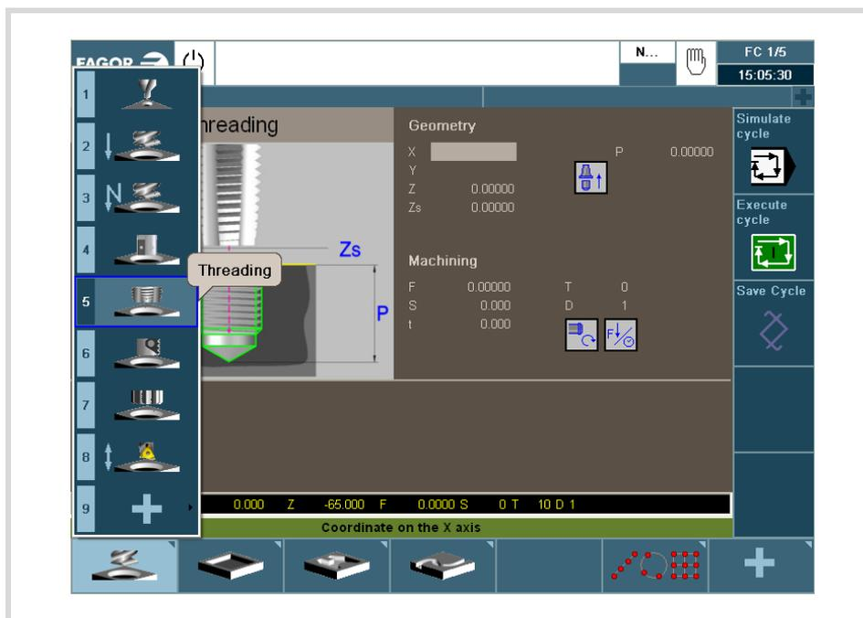
Après avoir sélectionné le cycle à éditer, saisir les données dans les fenêtres correspondant à chacun des paramètres de ce cycle. Pour valider chacun des paramètres et passer au suivant, taper sur [ENTER].
