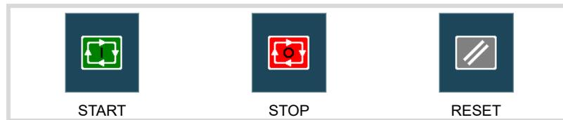
Une fois la simulation démarrée, elle continue jusqu'à ce que le cycle termine ou que l'on tape sur la softkey [RESET]. Même si en cours de simulation on change de cycle ou on revient à l'éditeur de programmes, le cycle précédent continue à être en vigueur dans la simulation.
